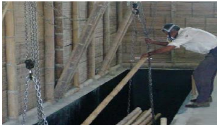
Figura 3. Curado del culmo (Salas Delgado, 2006)
