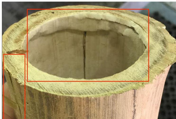
Figura 7. Falla por aplastamiento de las caras (Kosler & Carballo, 2018)
