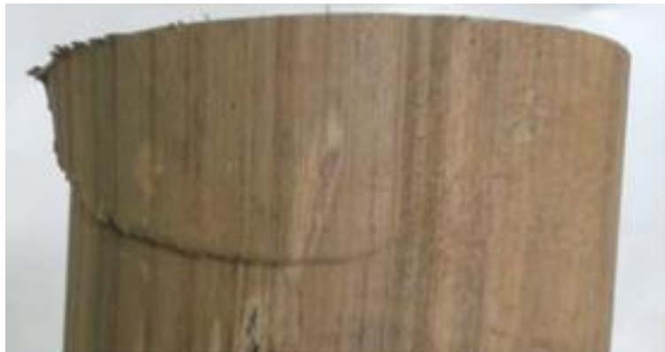
Figura 9. Falla por corte paralelo a la fibra (Kosler & Carballo, 2018)
