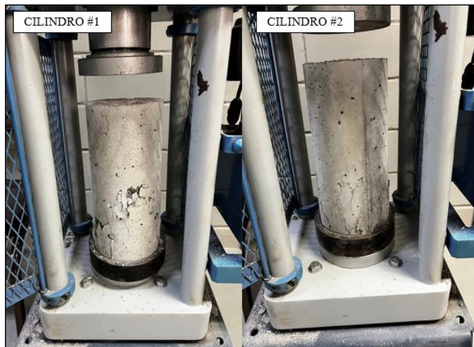
Figura 24. Fallas en los cilindros con sustitución del 2% S2%-2 a los 7 días. Tomado por Perdomo, 2023, Venezuela. Derechos reservados por autor.
