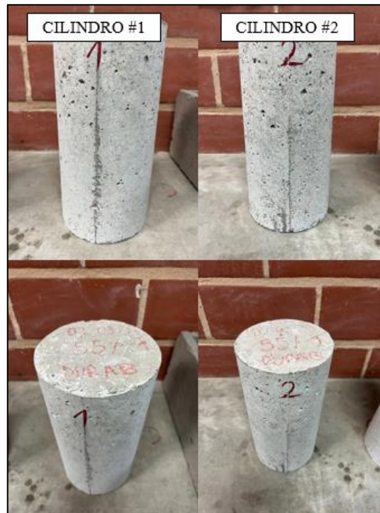
Figura 47. Aspecto de las probetas S5-1% luego del último ciclo de secado. Tomado por Perdomo, 2023, Venezuela. Derechos reservados por autor.
