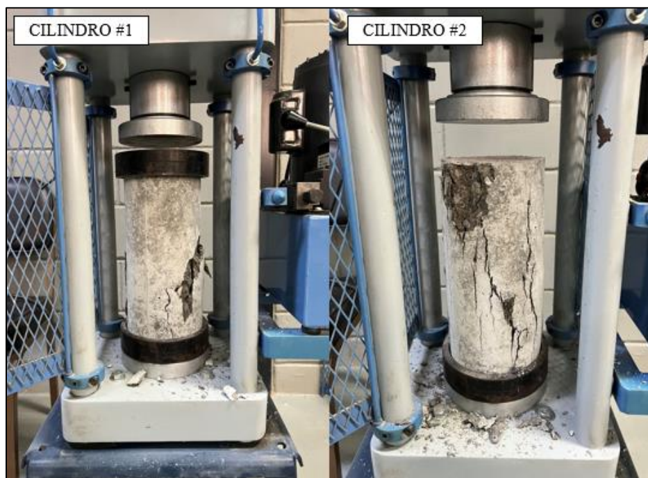
Figura 25. Fallas en los cilindros con sustitución del 2% S2%-1 a los 28 días. Tomado por Perdomo, 2023, Venezuela. Derechos reservados por autor.
