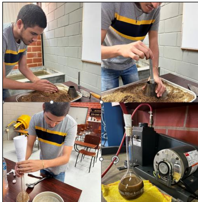
Figura 64. Preparación de agregado fino (arena) para ensayo de densidad y absorción. Tomada por Perdomo, 2022, Venezuela. Derechos reservados por autor.
