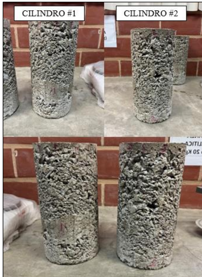
Figura 53. Aspecto de las probetas S10%-2 luego del último ciclo de secado. Tomado por Perdomo, 2023, Venezuela. Derechos reservados por autor.
