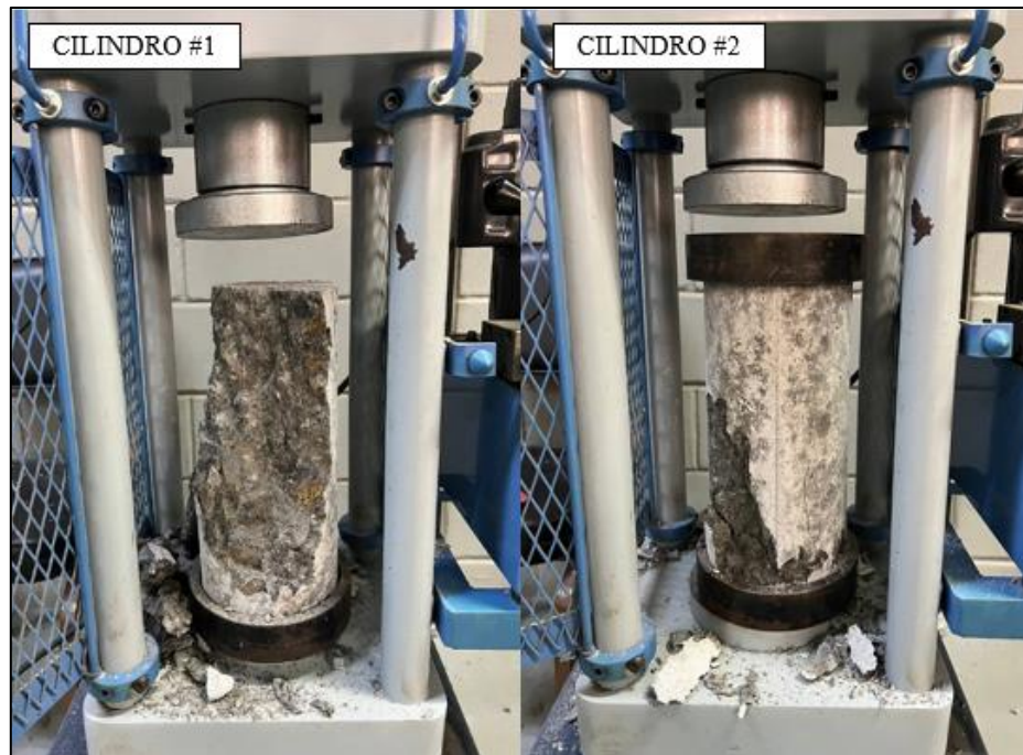
Figura 22. Fallas en los cilindros de concreto patrón MP-2 a los 28 días. Tomado por Perdomo, 2023, Venezuela. Derechos reservados por autor.
