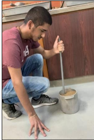
Figura 5. Golpes con barra compactadora para medición de agregado fino compactado. Tomada por Perdomo, 2023, Venezuela. Derechos reservados por autor.
