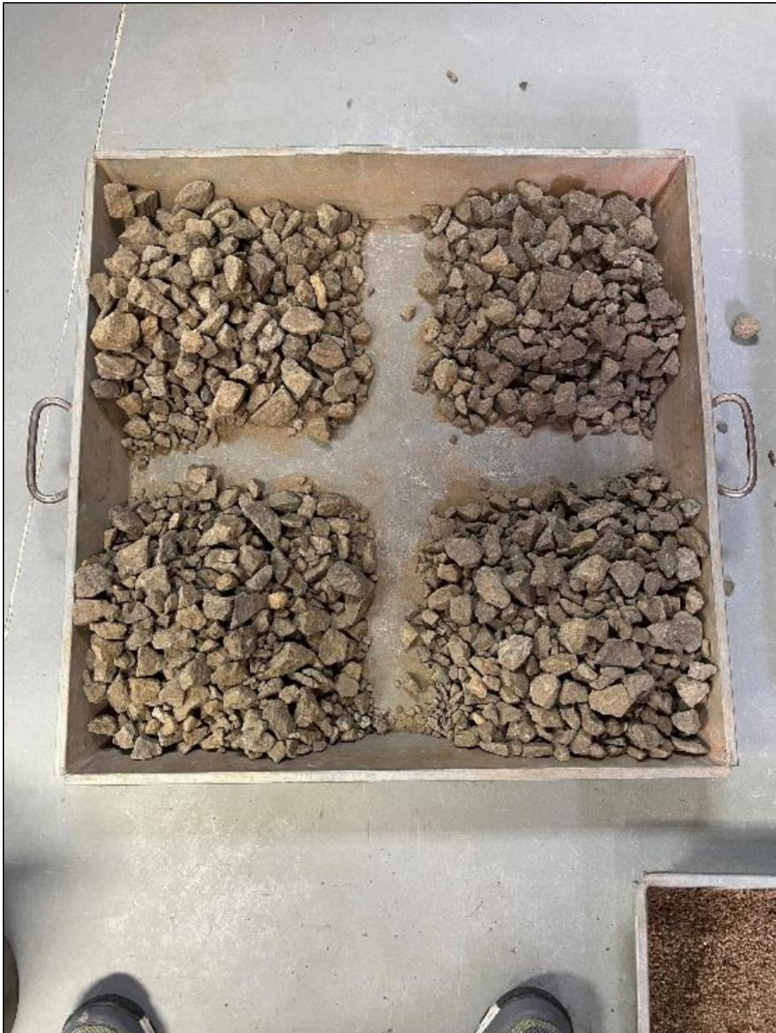
Figura 58. Cuarteo o separación de la muestra de agregado grueso (piedra) para ensayo de peso unitario. Tomada por Perdomo, 2022, Venezuela. Derechos reservados por autor.
