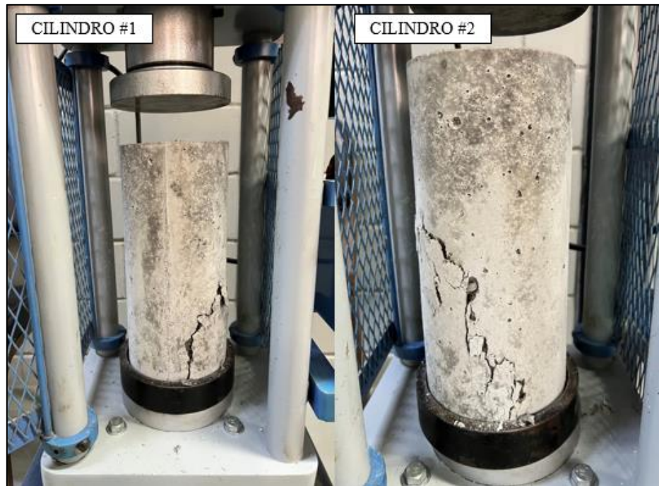
Figura 26. Fallas en los cilindros con sustitución del 2% S2%-2 a los 28 días. Tomado por Perdomo, 2023, Venezuela. Derechos reservados por autor.
