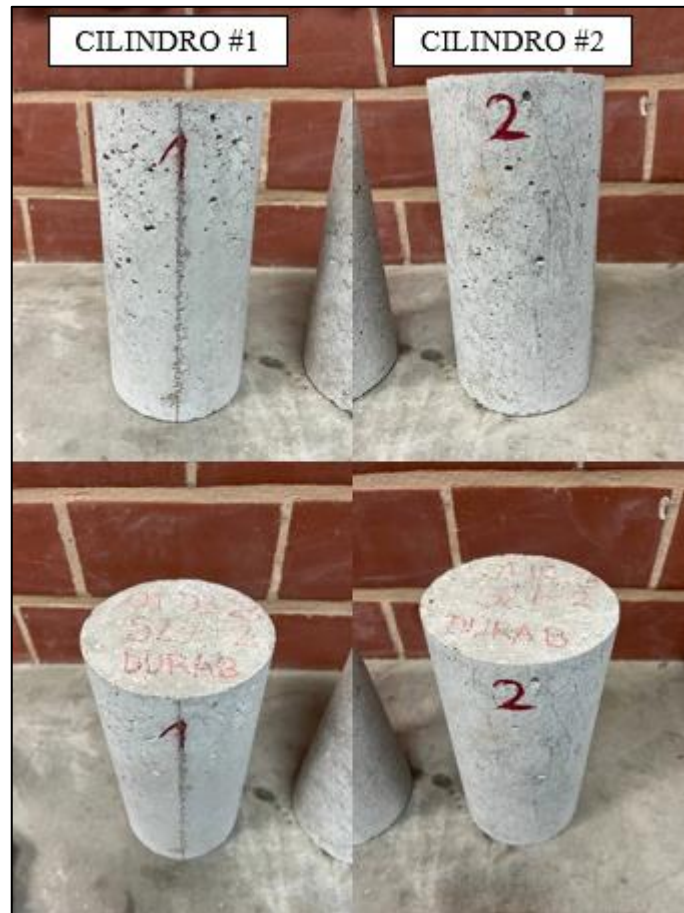
Figura 43. Aspecto de las probetas S2-2% luego del último ciclo de secado. Tomado por Perdomo, 2023, Venezuela. Derechos reservados por autor.
