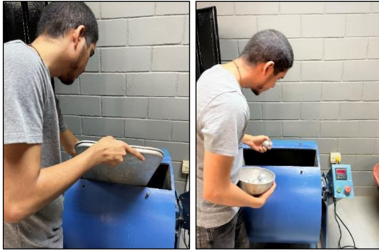
Figura 9. Introducción de muestra de agregado grueso y esferas de acero. Tomada por Perdomo, 2023, Venezuela. Derechos reservados por autor.
