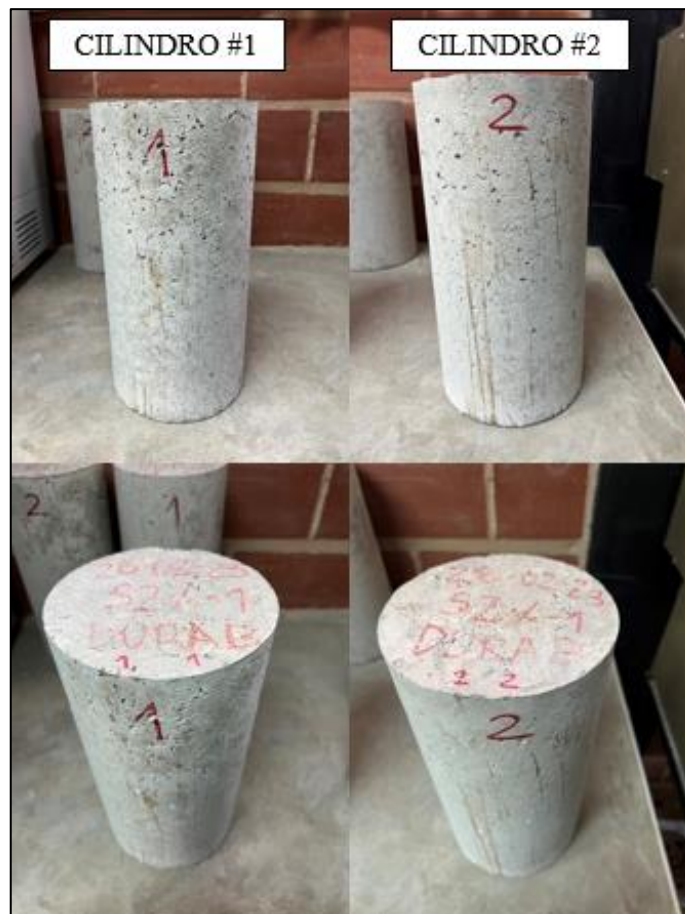
Figura 42. Aspecto de las probetas S2-1% luego del último ciclo de secado. Tomado por Perdomo, 2023, Venezuela. Derechos reservados por autor.
