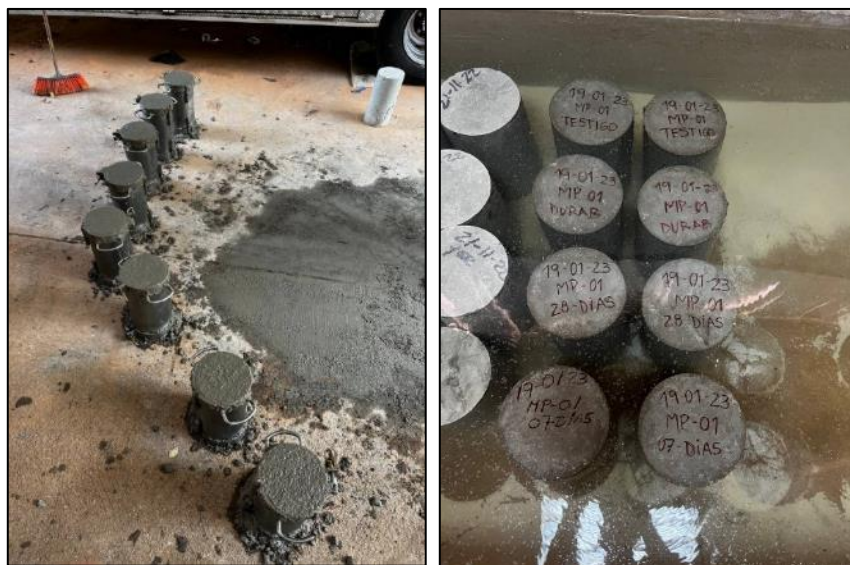
Figura 12. Vaciado de los cilindros y curado de los mismos en las instalaciones del Laboratorio de materiales. Tomada por Perdomo, 2023, Venezuela. Derechos reservados por autor.
