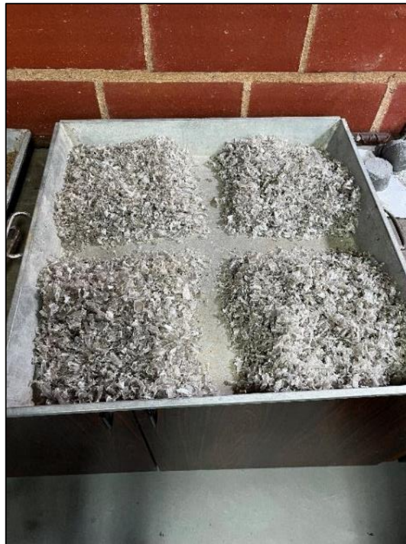
Figura 60. Cuarteo o separación de la muestra de agregado grueso (plástico) para ensayo de peso unitario. Tomada por Perdomo, 2022, Venezuela. Derechos reservados por autor.
