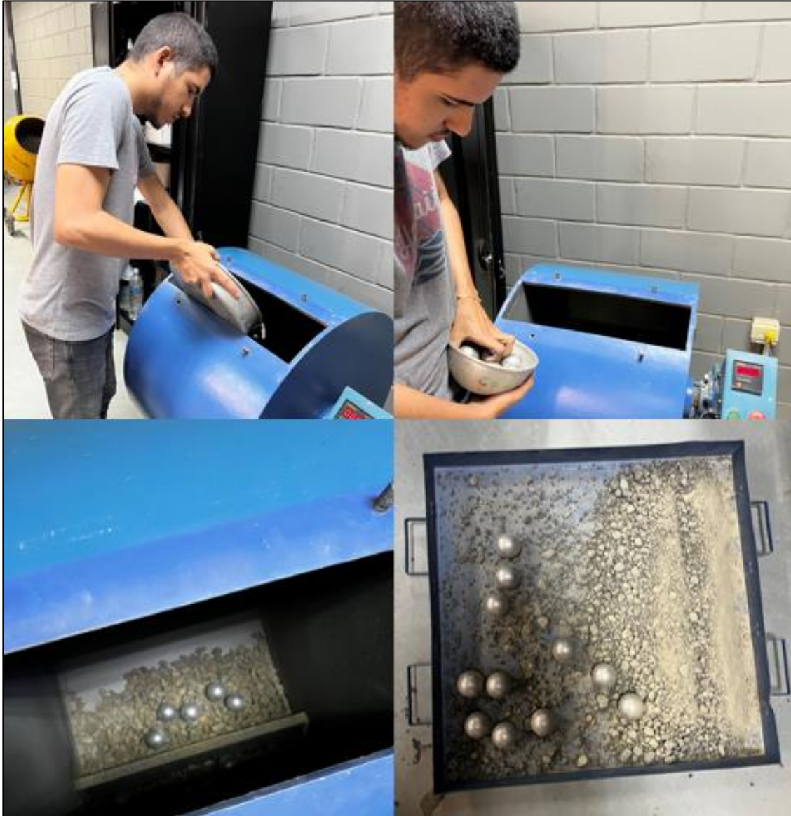
Figura 65. Introducción de muestra y esferas para ensayo de resistencia al desgaste de agregado grueso. Tomada por Perdomo, 2023, Venezuela. Derechos reservados por autor.
