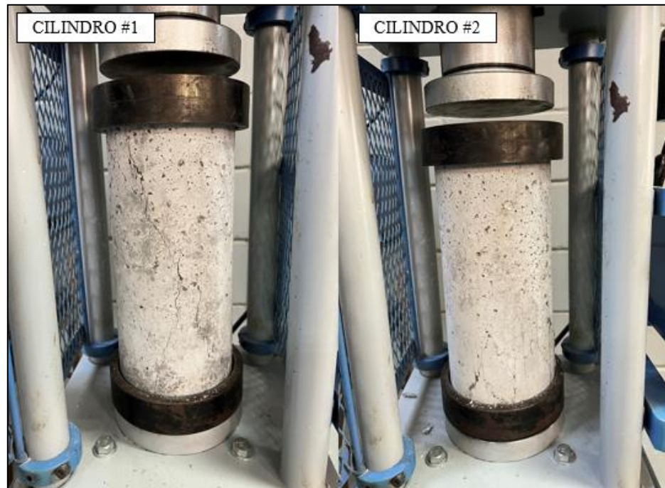
Figura 28. Fallas en los cilindros con sustitución del 5% S5%-2 a los 7 días. Tomado por Perdomo, 2023, Venezuela. Derechos reservados por autor.
