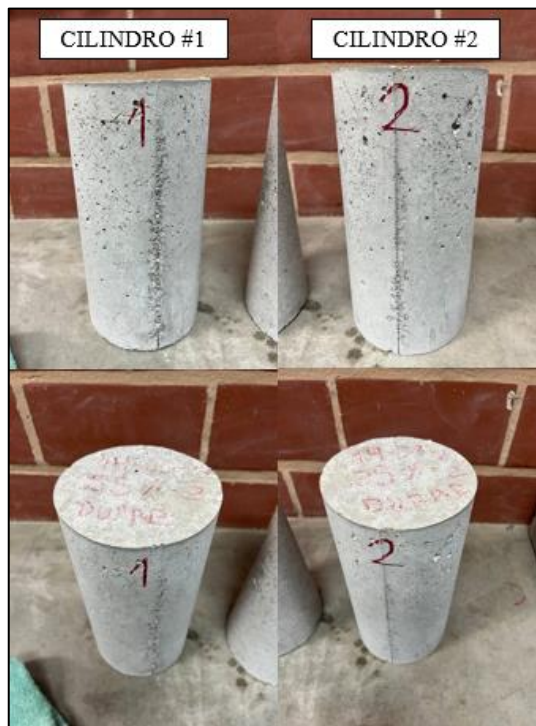
Figura 48. Aspecto de las probetas S5-2% luego del último ciclo de secado. Tomado por Perdomo, 2023, Venezuela. Derechos reservados por autor.
