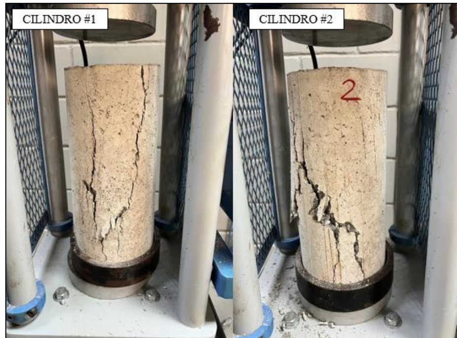
Figura 44. Fallas en los cilindros de concreto patrón S2%-1 finalizado el último ciclo de secado. Tomado por Perdomo, 2023, Venezuela. Derechos reservados por autor.
