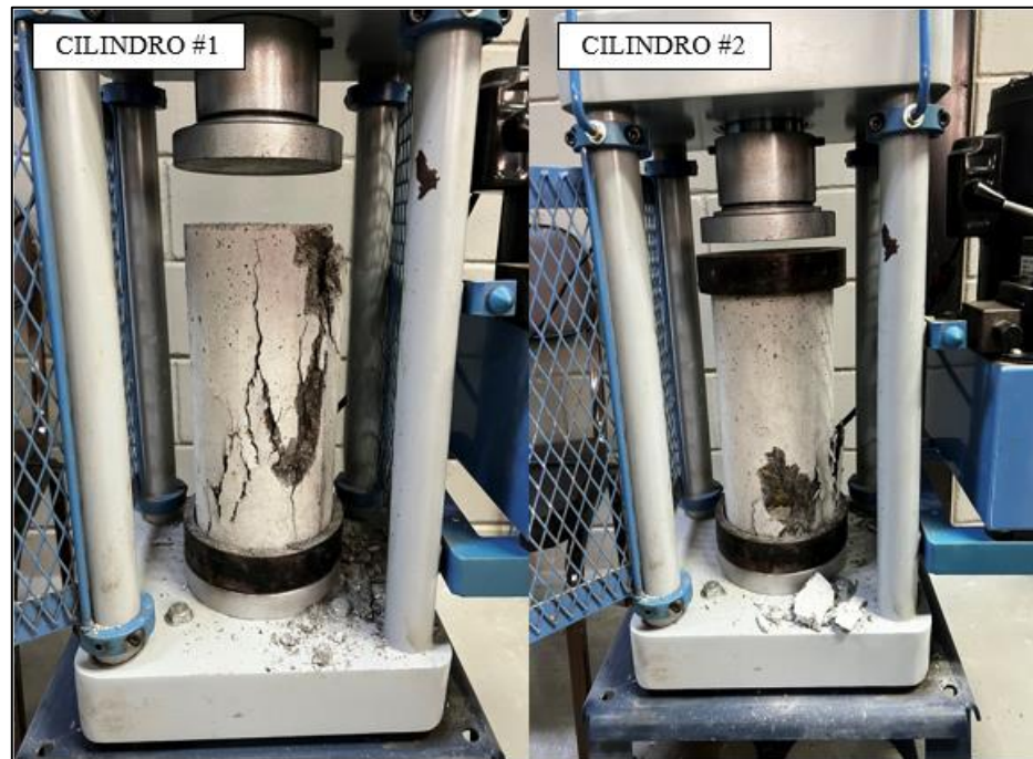
Figura 20. Fallas en los cilindros de concreto patrón MP-2 a los 7 días. Tomado por Perdomo, 2023, Venezuela. Derechos reservados por autor.
