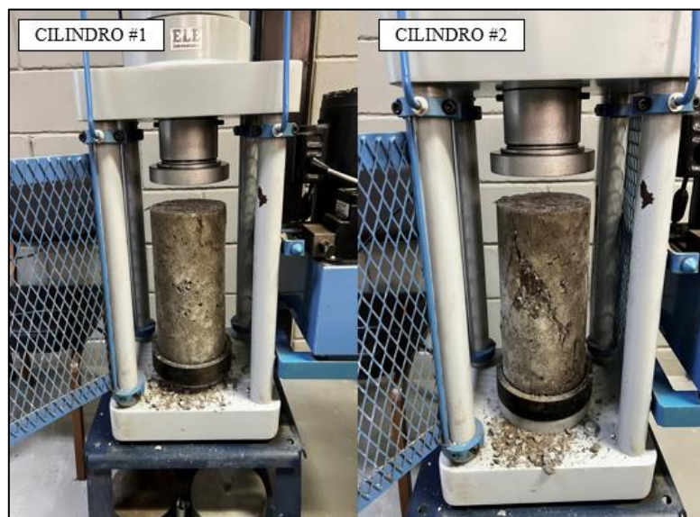
Figura 31. Fallas en los cilindros con sustitución del 10% S10%-1 a los 7 días. Tomado por Perdomo, 2023, Venezuela. Derechos reservados por autor.
