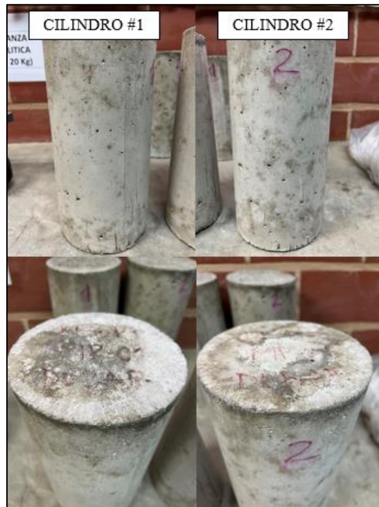
Figura 37. Aspecto de las probetas MP-1 luego del último ciclo de secado. Tomado por Perdomo, 2023, Venezuela. Derechos reservados por autor.
