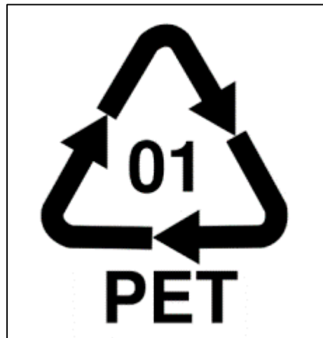
Figura 2. Símbolo del Polietileno tereftalato (PET). Tomado de Reciclado de Plástico PET , (p.17), por J. Bolaños, 2019. Derechos reservados por Juan José Bolaños.
