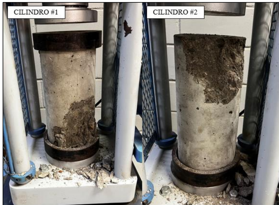
Figura 19. Fallas en los cilindros de concreto patrón MP-1 a los 7 días. Tomado por Perdomo, 2023, Venezuela. Derechos reservados por autor.
