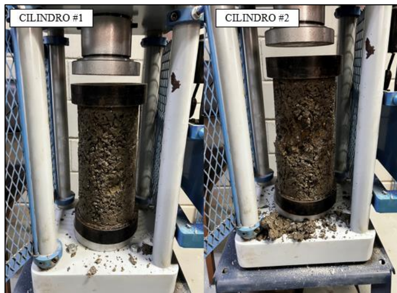
Figura 32. Fallas en los cilindros con sustitución del 10% S10%-2 a los 7 días. Tomado por Perdomo, 2023, Venezuela. Derechos reservados por autor.
