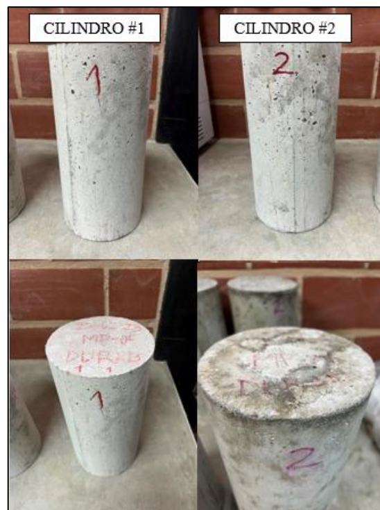
Figura 38. Aspecto de las probetas MP-2 luego del último ciclo de secado. Tomado por Perdomo, 2023, Venezuela. Derechos reservados por autor.
