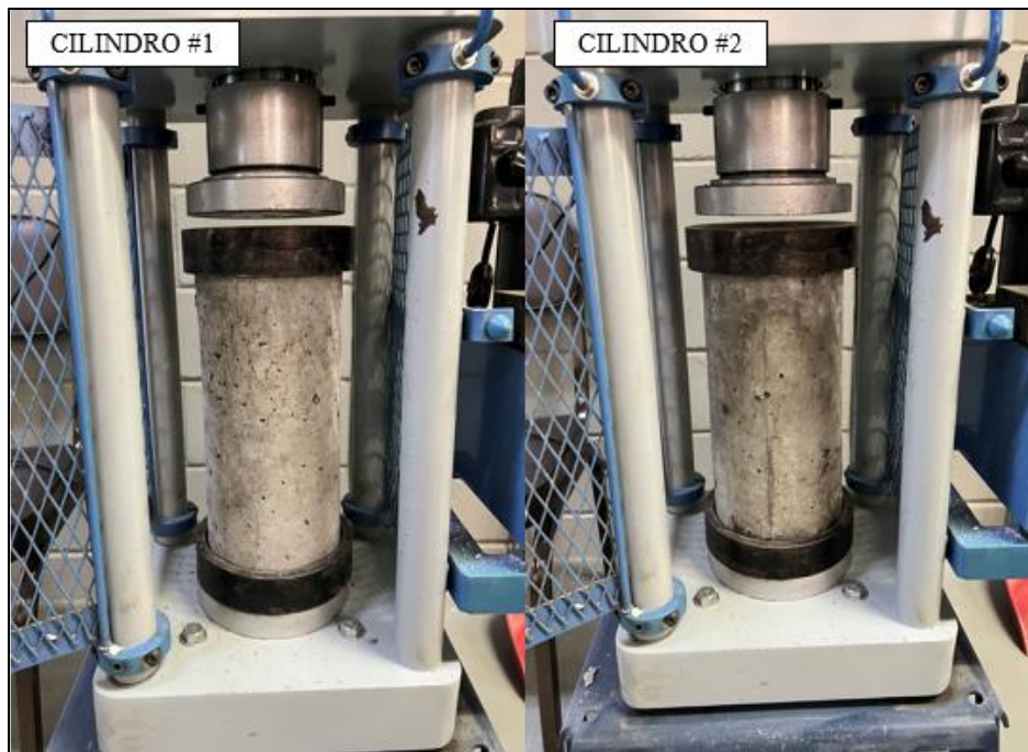
Figura 27. Fallas en los cilindros con sustitución del 5% S5%-1 a los 7 días. Tomado por Perdomo, 2023, Venezuela. Derechos reservados por autor.
