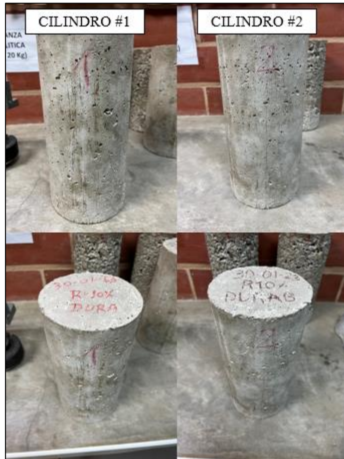
Figura 52. Aspecto de las probetas S10%-1 luego del último ciclo de secado. Tomado por Perdomo, 2023, Venezuela. Derechos reservados por autor.
