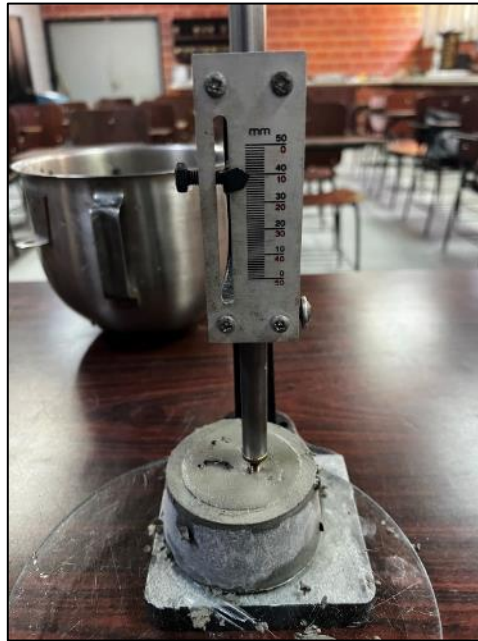
Figura 11. Aguja de Vicat indicando la consistencia normal del cemento al descender 10 mm. Tomada por Perdomo, 2023, Venezuela. Derechos reservados por autor.
