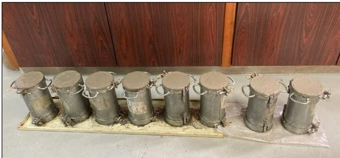
Figura 68. Probetas en moldes cilíndricos para su posterior secado, desmoldado y curado. Tomada por Perdomo, 2023, Venezuela. Derechos reservados por autor.
