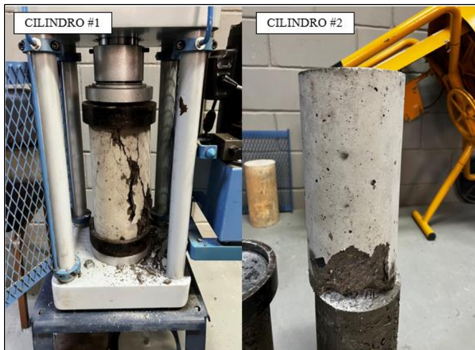
Figura 21. Fallas en los cilindros de concreto patrón MP-1 a los 28 días. Tomado por Perdomo, 2023, Venezuela. Derechos reservados por autor.
