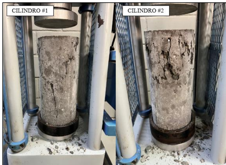
Figura 30. Fallas en los cilindros con sustitución del 5% S5%-2 a los 28 días. Tomado por Perdomo, 2023, Venezuela. Derechos reservados por autor.
