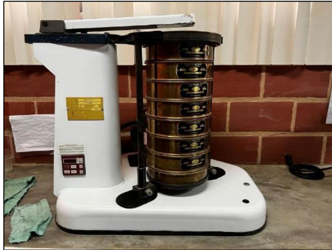
Figura 8. Cernidora mecánica y tamices utilizados. Tomada por Perdomo, 2023, Venezuela. Derechos reservados por autor.
