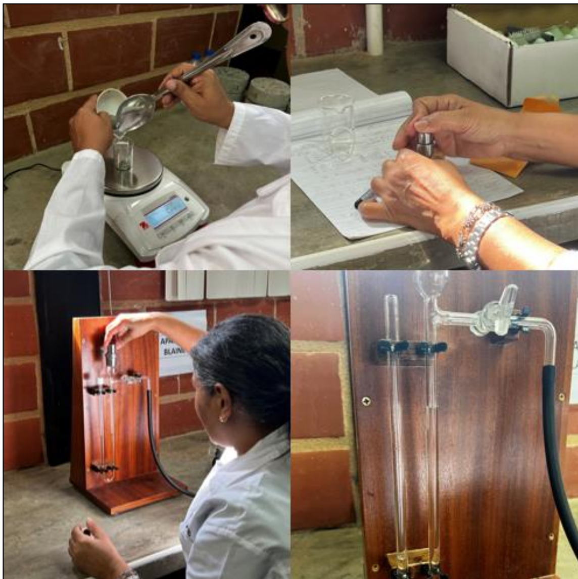
Figura 66. Preparación de muestra y medición de ensayo de Finura de Blaine. Tomada por Perdomo, 2023, Venezuela. Derechos reservados por autor.
