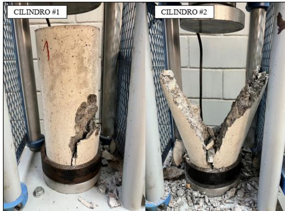
Figura 40. Fallas en los cilindros de concreto patrón MP-2 finalizado el último ciclo de secado. Tomado por Perdomo, 2023, Venezuela. Derechos reservados por autor.
