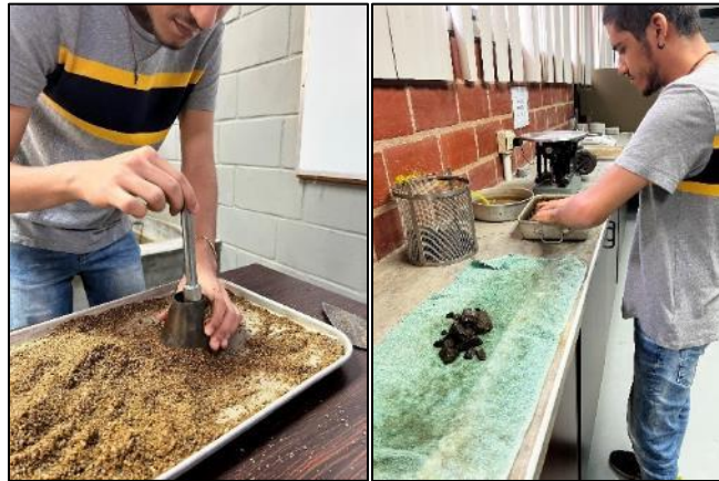
Figura 6. Elaboración del ensayo de absorción en agregado fino y agregado grueso, procedimiento para obtener muestra saturada con superficie seca. Tomada por Perdomo, 2023, Venezuela. Derechos reservados por autor.
