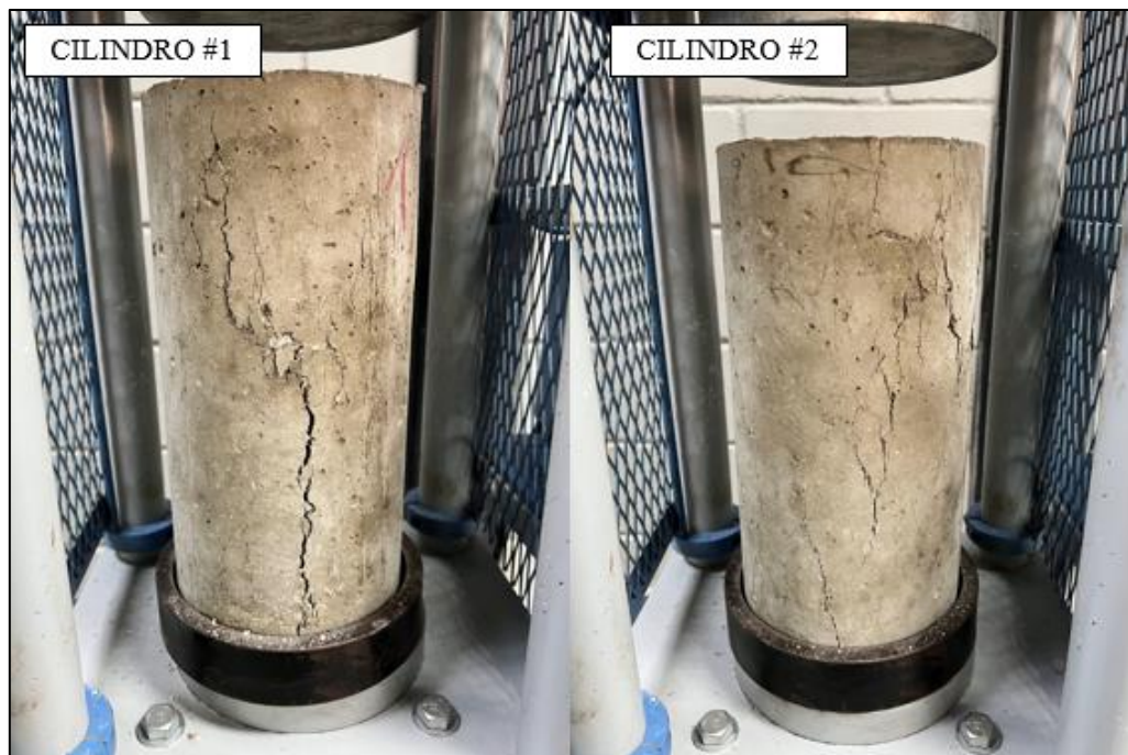
Figura 54. Fallas en los cilindros de concreto con sustitución S10%-1 finalizado el último ciclo de secado. Tomado por Perdomo, 2023, Venezuela. Derechos reservados por autor.
