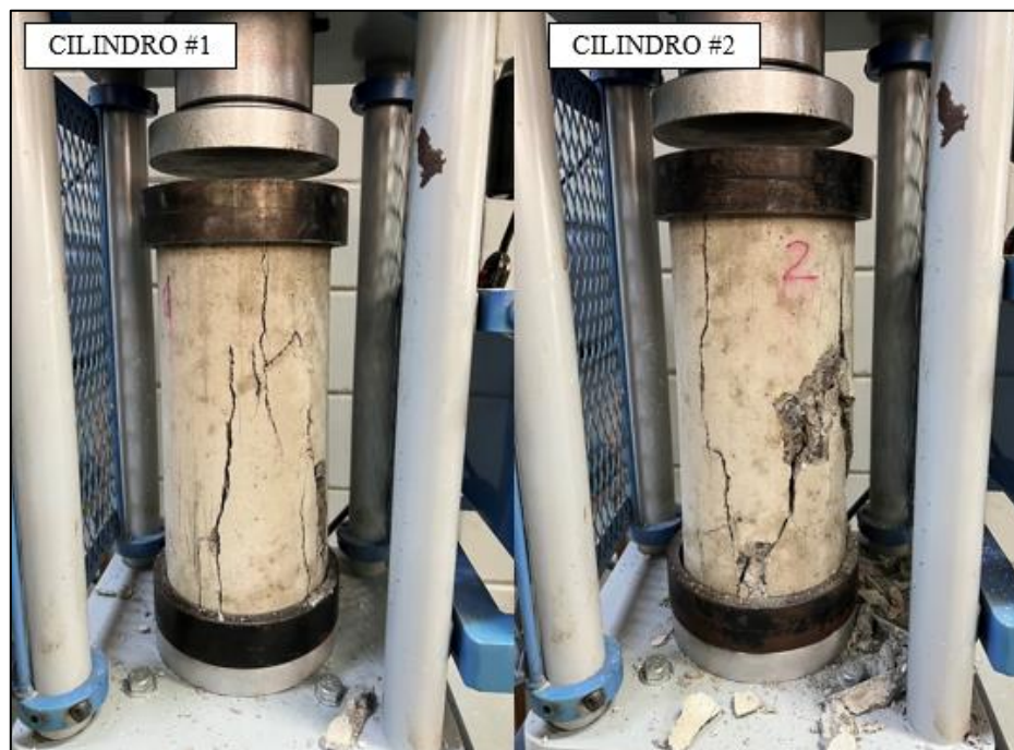
Figura 39. Fallas en los cilindros de concreto patrón MP-1 finalizado el último ciclo de secado. Tomado por Perdomo, 2023, Venezuela. Derechos reservados por autor.
