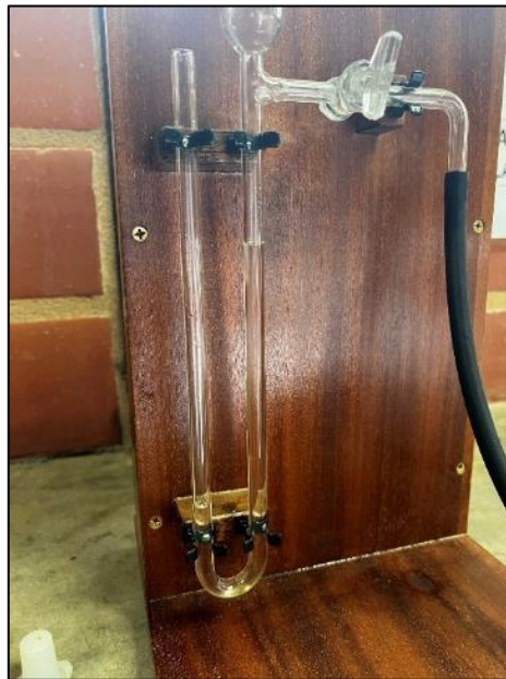
Figura 10. Aparato de Blaine para la elaboración del ensayo de finura del cemento Portland. Tomada por Perdomo, 2023, Venezuela. Derechos reservados por autor.
