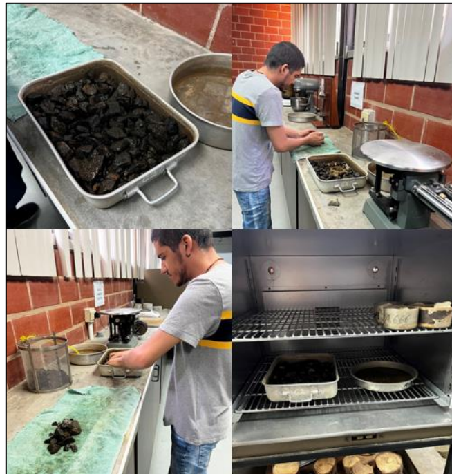
Figura 63. Preparación y secado de agregado grueso (piedra) para ensayo de densidad y absorción. Tomada por Perdomo, 2022, Venezuela. Derechos reservados por autor.
