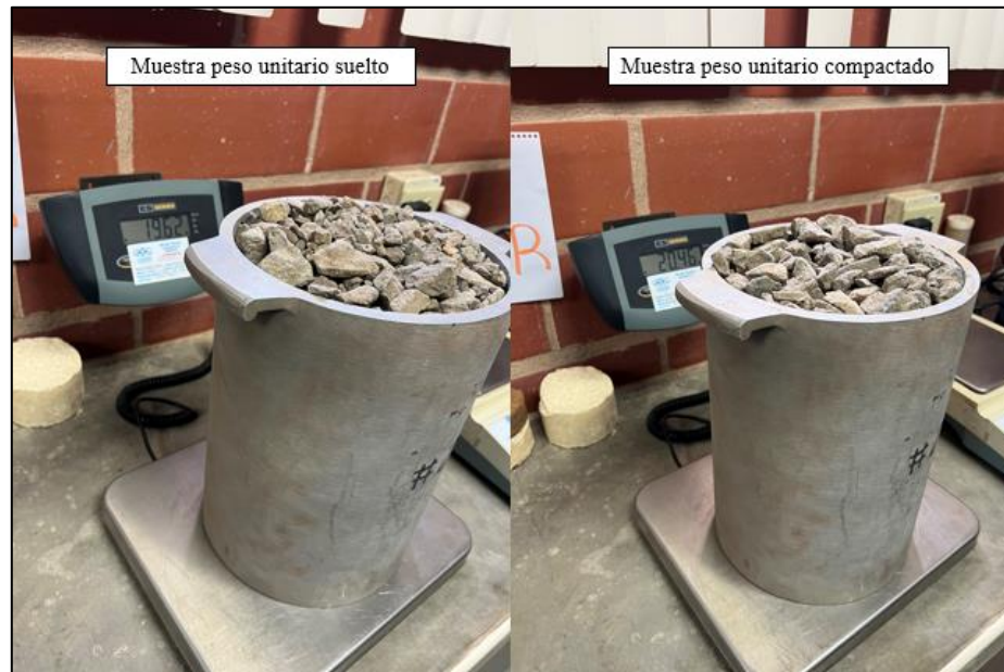
Figura 59. Muestra de agregado grueso (piedra) para peso unitario suelto y compactado. Tomada por Perdomo, 2022, Venezuela. Derechos reservados por autor.
